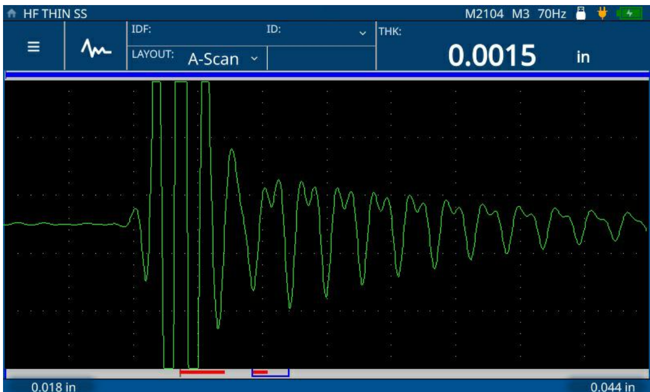
M2104(125MHz) 탐촉자를 사용한 72DL PLUS 두께 측정기의 얇은 강판(두께 0.0015인치, 즉 0.0381mm) 측정
